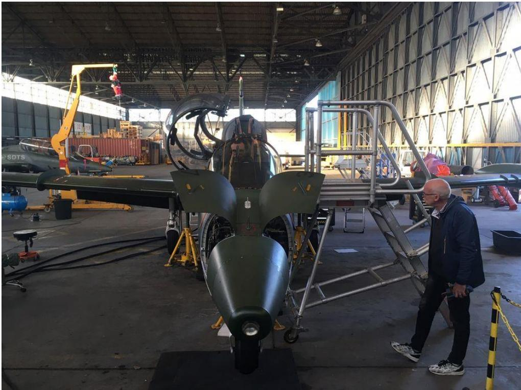
*Train d'atterrissage, aérofrein... Les systèmes hydrauliques de cet appareil sont testés au sol lors de sa révision des 300 heures.*
